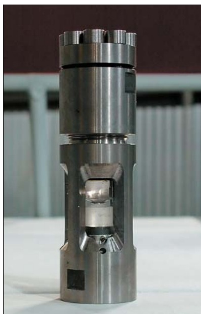
Рис.10. Ячейка с наковальнями из монокристаллов сапфира, используемая на реакторе ИБР-2 в структурных экспериментах с высоким внешним давлением. Объем образца, помещаемого между наковальнями, составляет несколько кубических миллиметров, максимальное давление — около 70 кбар. Размер ячейки по вертикали — около 15 см.
